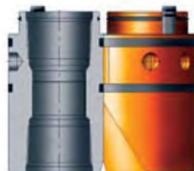
SUSPENSOR DUAL MODELO WCBE COM LINHA DE CONTROL WCBE DUAL HANGER WITH CONTROL LINE COLGADOR DUAL MODELO WCBE CON LINEA DE CONTROL
